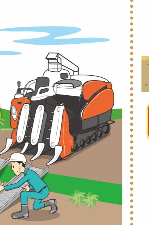
當段差超過10cm時，採用4倍以上的斜坡台來移動。
